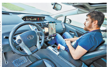
Беспилотнику пока еще требуется водитель, чтобы в экстренной ситуации взять управление на себя.
